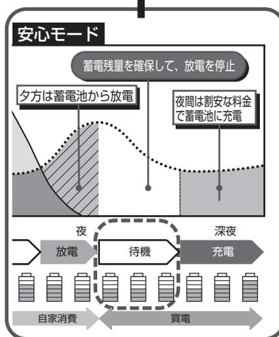
**安心モード**では、蓄電残量を一定量確保して、緊急時に備えます。(他の動作は、経済モードと同じです。)
