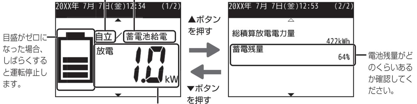
「放電」と表示され、特定負荷用分電盤または特定負荷用コンセントへの供給電力が表示されます。
