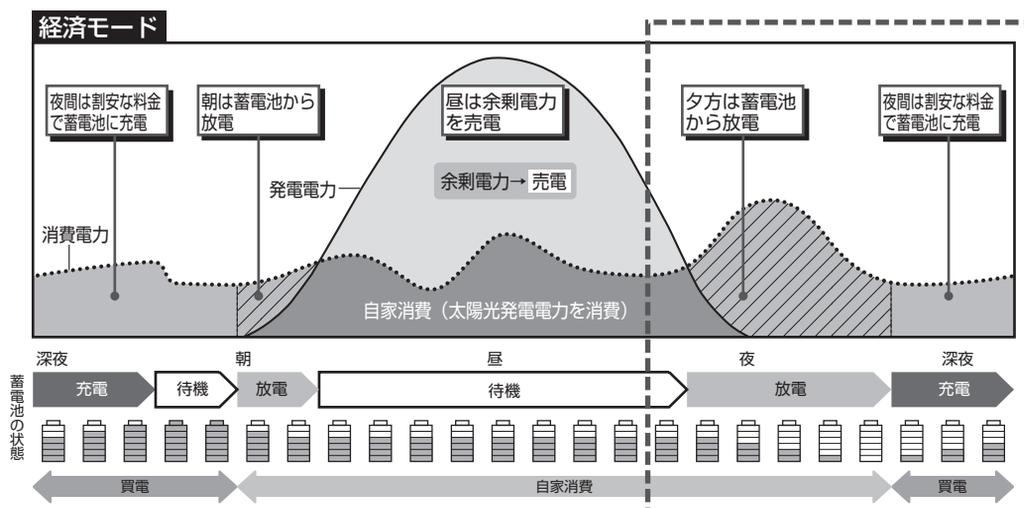
**経済モード**では、電気料金の割安な夜間に蓄電池ユニットに充電し、電気料金の割高な日中に蓄電池ユニットから放電することで電気代を節約します。昼間に太陽光発電の余剰電力を売電している場合は蓄電池ユニットから放電しません。
