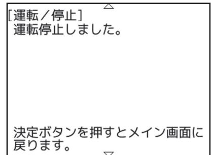
長時間の運転停止は行わないでください。運転停止状態が長時間続くと、蓄電池ユニットが完全放電し、蓄電池ユニットが使用できなくなる場合があります。
